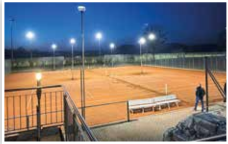
An den Plätzen 1, 3 und 4 sorgen zehn Lichtmasten mit einer Lichtleistung von 217000 Lumen pro Platz für professionelles LED Flutlicht-Ambiente
